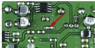
図3： 基板底面のハンダパッドをブリッジします。
